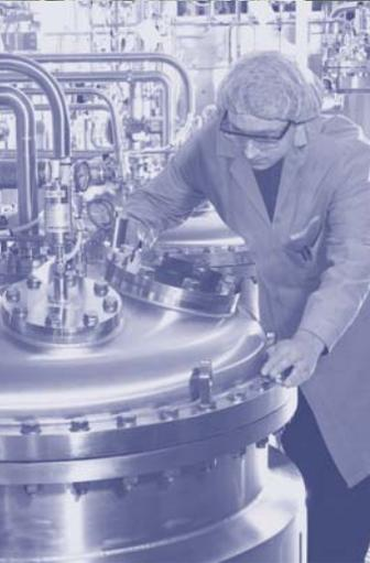
Gentechnische Produktionsanlage: In großen Stahltanks werden mit gentechnisch veränderten Zellen Wirkstoffe produziert
