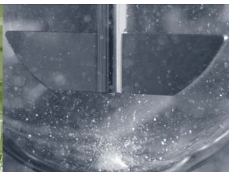
Eine Galenikerin prüft in einer Rühranlage, ob die neuen Tabletten in der vorgesehenen Zeit in Flüssigkeit zerfallen und den Wirkstoff freisetzen.
